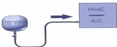
Abrir la válvula del tubo flexible para efectuar el lavado (SUPER-FLUSH) y el barrido (NITRÓGENO) a la instalación
